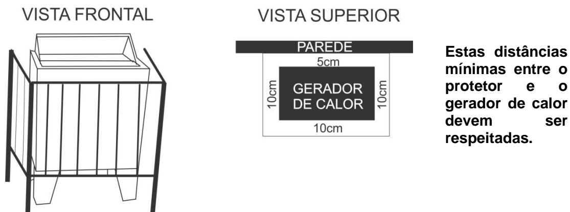
Figura 9: Posicionamento do protetor em U – linha STAR
